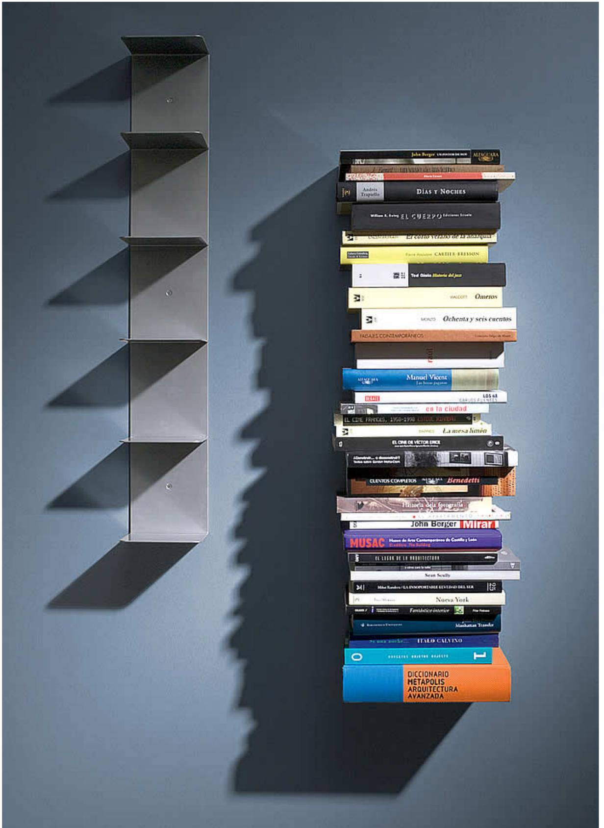
Consiste simplemente en una serie de 6 baldas de reducidas dimensiones (12x12 cm) separadas una distancia de 15 cm. entre sí, unidas por su arista posterior a una chapa vertical que unifica la columna y permite, mediante 3 taladros avellanados contenidos en ella, la fijación del conjunto a la pared.
